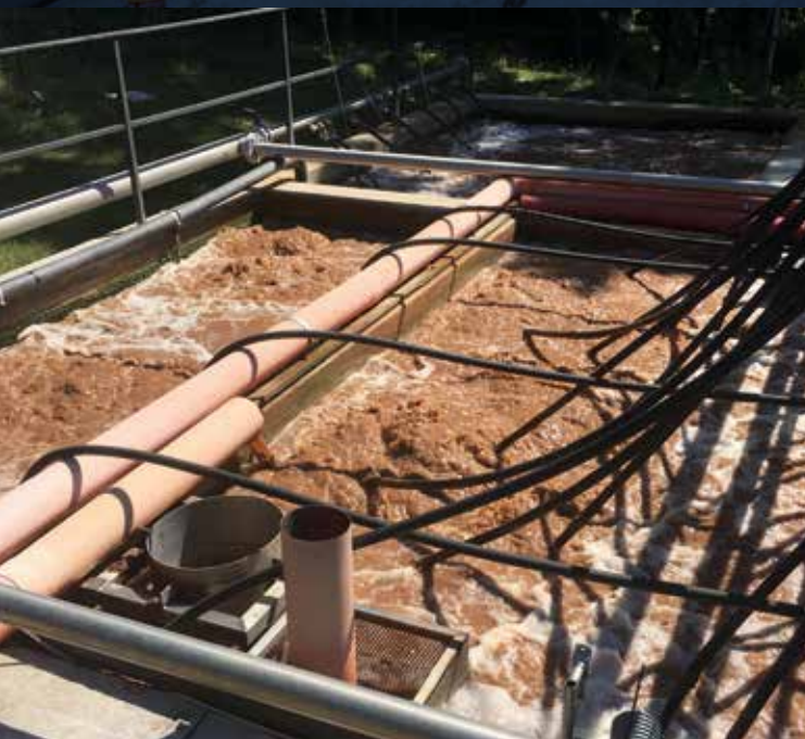
Impianto MBBR per settore birrario con SAGM (PU) MBBR Plant for brewing industry with SAGM (Pesaro Urbino - Italy)
