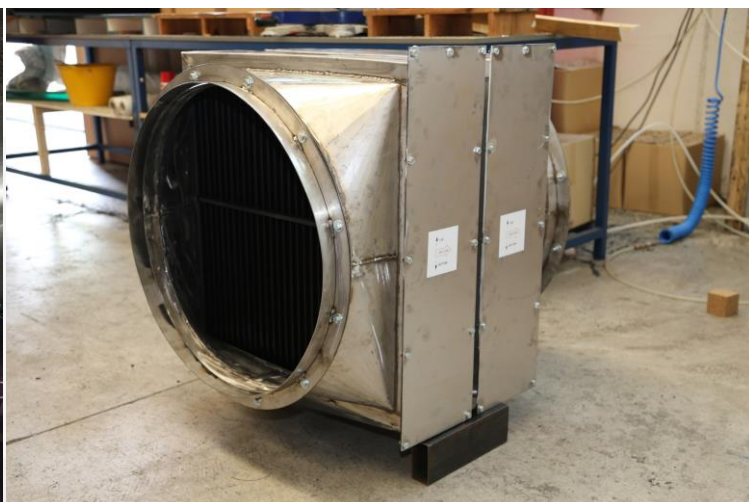
Sistema di rimozione gocce per un impianto di aspirazione aria + fibre di vetro
