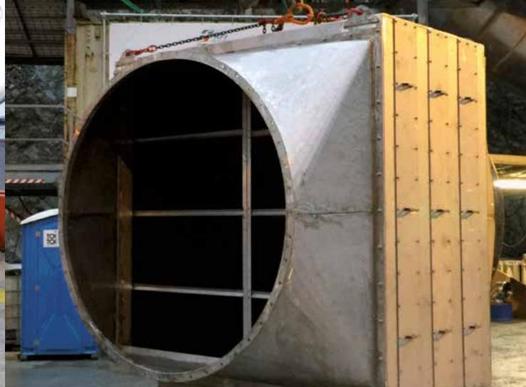
Progettazione e realizzazione di sistemi "box type" per grossi impianti di canalizzazione. Sia per la rimozione di gocce liquide di processo, sia in sistemi di umidificazione di correnti di aria secca.
