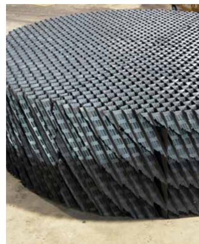
I pacchi lamellari consentono di aumentare la superficie di sedimentazione per il trattamento primario delle acque in ingresso agli allevamenti o per abbattere i solidi sedimentabili nelle acque reflue. Si adattano facilmente a strutture già esistenti, sono modulari e possono essere realizzati su misura, sagomati anche in forma circolare.
