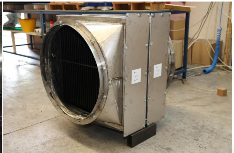
Sistema di rimozione gocce per un impianto di aspirazione aria + fibre di vetro
